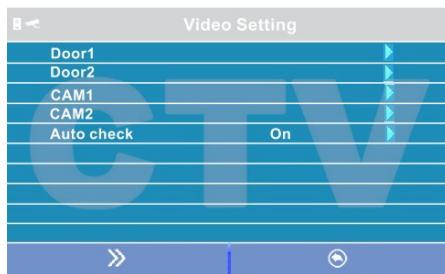
Параметры «Панель1», «Панель2», «Камера1» и «Камера2» используются для указания стандарта, разрешения и формата видеосигнала по выбранному каналу вручную. Выберите нужный канал и нажмите на кнопку «Меню», откроется окно:
